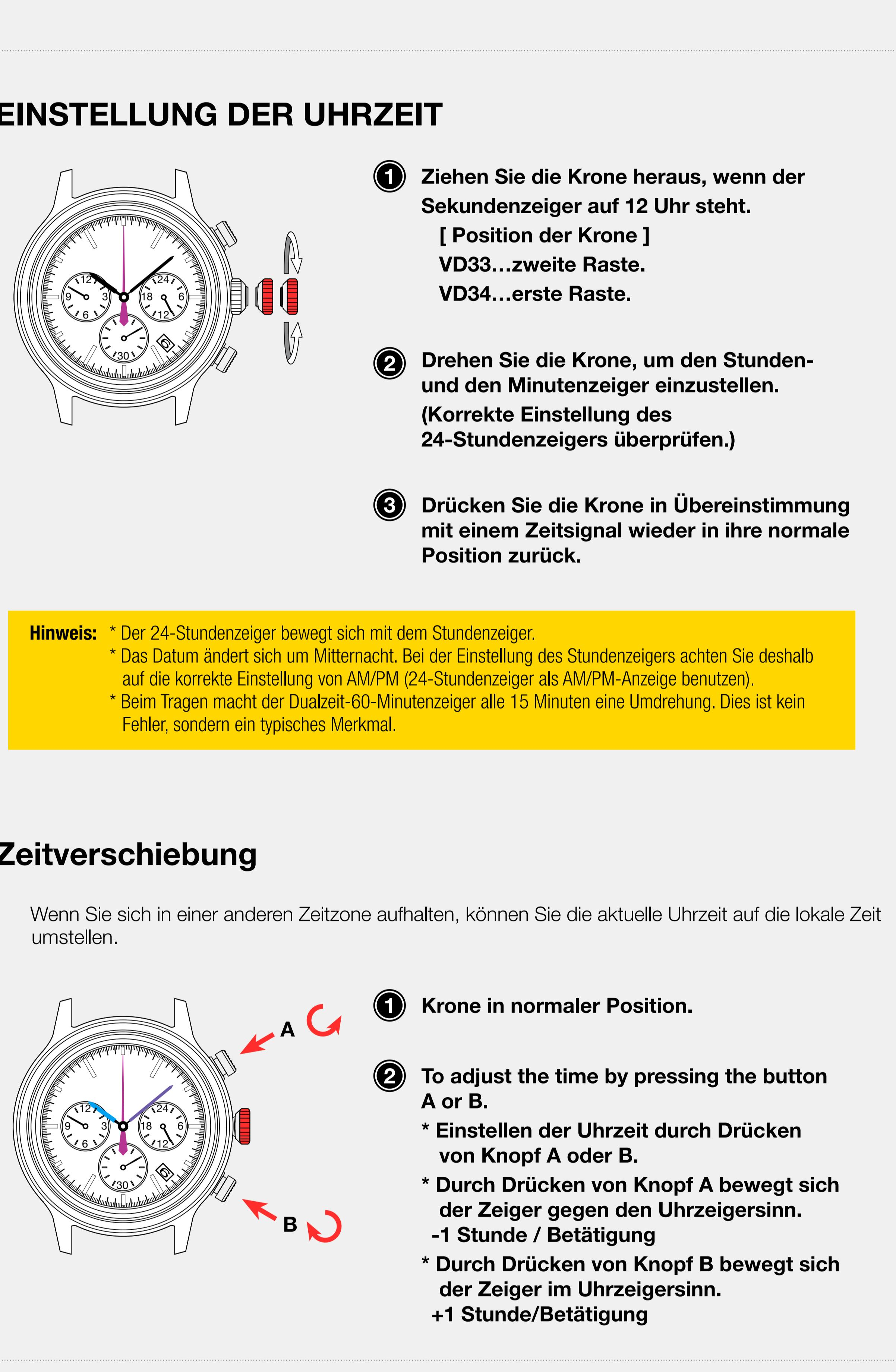
**Hinweis:** \* Bitte wiederholen Sie die vier Schritte der oben beschriebenen Einstellung für die Position 0, wenn der Dualzeit-60-Minutenzeiger sich wie folgt bewegt; Bis zu 1 bis 14 Minuten, ein Schritt/Betätigung, bei 15 Minuten wird eine Umdrehung/Betätigung wiederholt.
